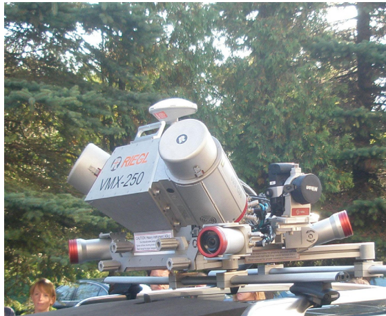
Rys. 7. System VMX-250 z dodatkowymi kamerami Nikon 700
